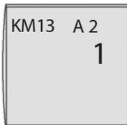
Изменить порядковый номер включения в каскаде со 2 на 1 котла с адресом 1
