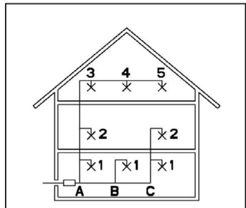
Рис. Последовательность промывки
