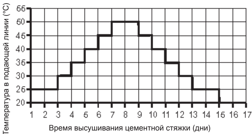
Рис.: Временная зависимость температуры в подающей линии при высушивании цементной стяжки
