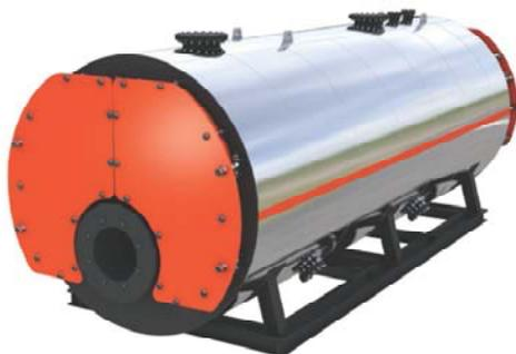
Водогрейные котлы Unitherm предназначены для получения горячей воды с рабочим давлением до 1,0 (10,0) МПа (кгс/см<sup>2</sup>) и 0,6 (6,0) МПа (кгс/см<sup>2</sup>), и допустимой температурой 150 и 115 °С соответственно.
