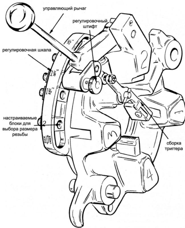
6. Поворачивайте регулировочную шкалу против часовой стрелки пока штифт ножа № 2 не освободится, после этого можно вынуть нож № 2.
