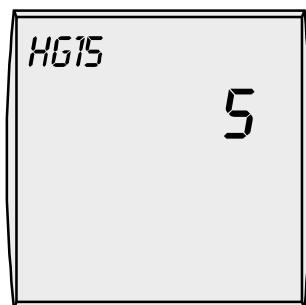
В данном параметре определяется точка включения и выключения загрузки бойлера. Чем больше разница между температурой включения и выключения загрузки бойлера, тем больше отклонение температуры бойлера от ном. значения.
