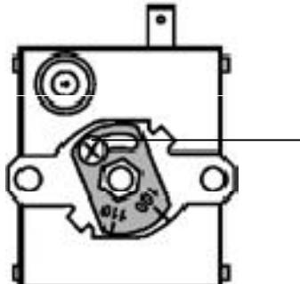
Отвинтить крепежные винты передней крышки устройства регулирования, и откинуть ее вперед.
