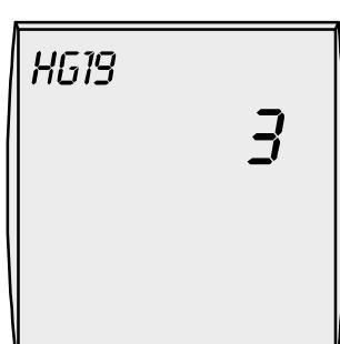
После завершения загрузки бойлера (температура бойлера достигла установленного значения) насос загрузки бойлера продолжает работать по инерции не более установленного времени. Если в течении этого времени температура воды в бойлере охладится так, что разница между температурой котла и температурой бойлера составит 5K, то насос загрузки бойлера отключается преждевременно, чтобы предотвратить охлаждение котла.
